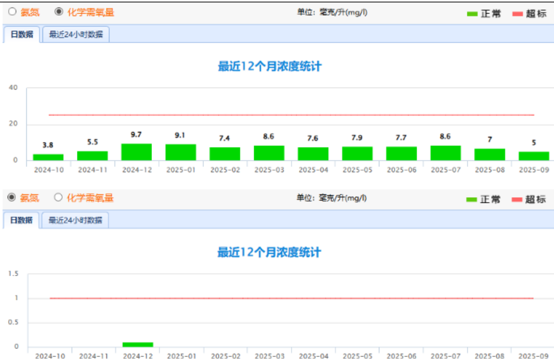
图4 污水处理厂出水 COD、氨氮在线监测数据
